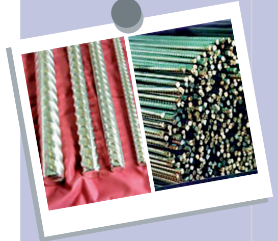
Şekil 42. Düz ve nervürlü inşaat çeliği.
