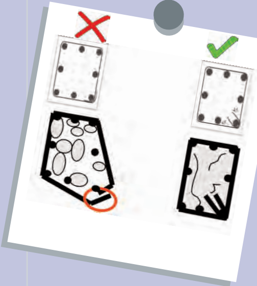
Şekil 45. Hatalı etriye uygulaması nedeniyle betonun dağılması.
